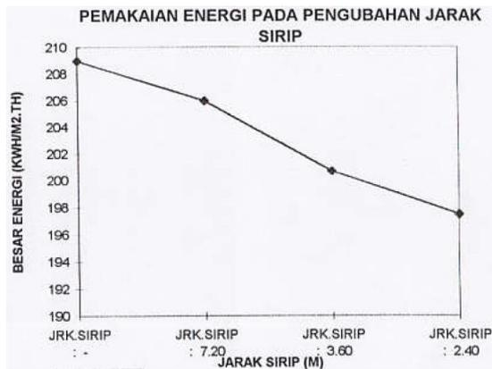
Diagram 3. Reduksi pemakaian energi bangunan akibat pemakaian Sirip (fin) dengan jarak yang berbeda-beda
